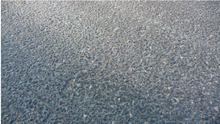
Figur 21 - Hjäggmark, 2000-2012, "16 Ö", färskt stenmaterial. Slitlager gjort med PEN 330/430 och bärlagret med PEN 160/220. Inget visuellt stensläpp
